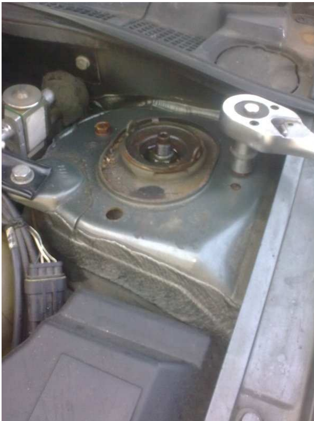
6.ściągnaczem do sprężyn ściskamy sprężynę na tyle by móc swobodnie odkręcić nakrętkę i zdjąć górną poduszkę
