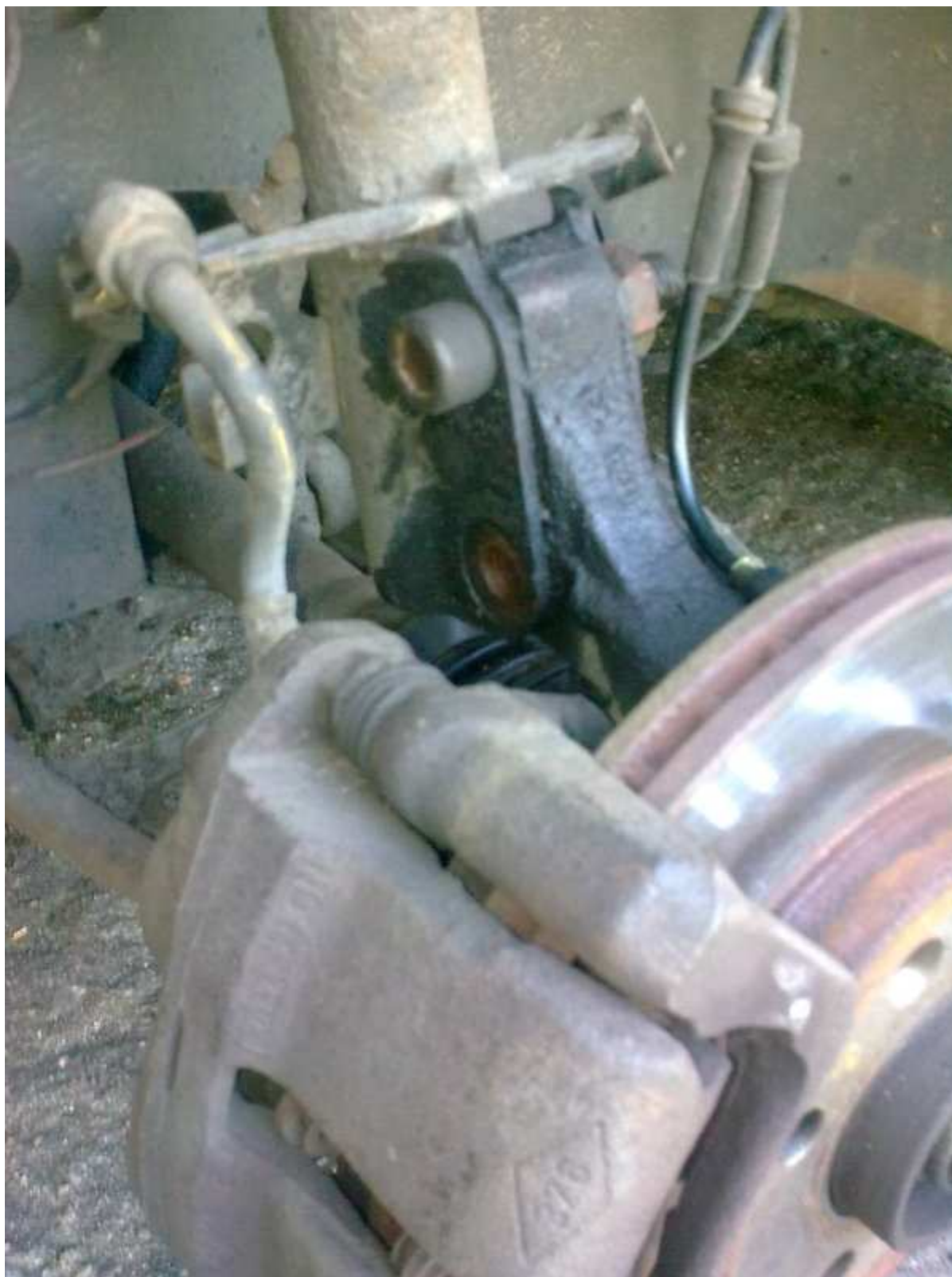
3. odpinamy z uchwytu przewód hamulcowy oraz przewód od Abs .
