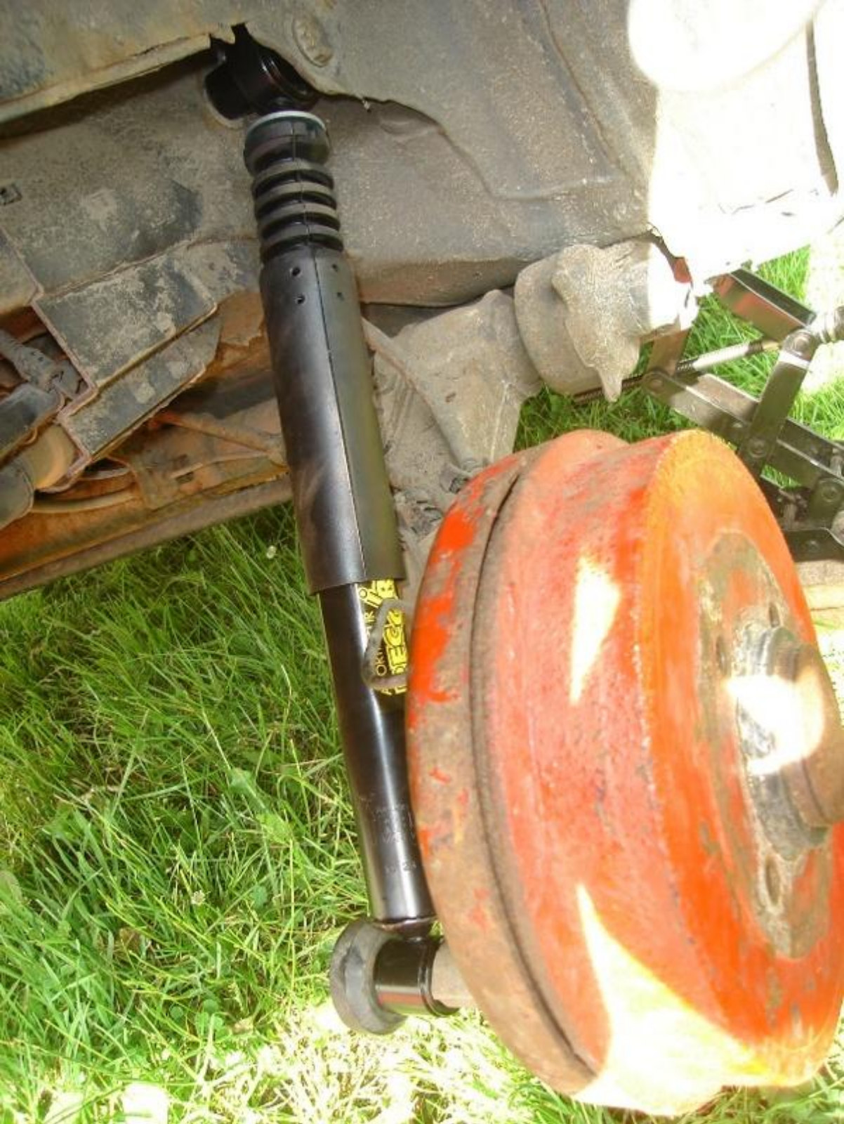
6. Zakładamy nowy amortyzator i skręcamy śrubami .
